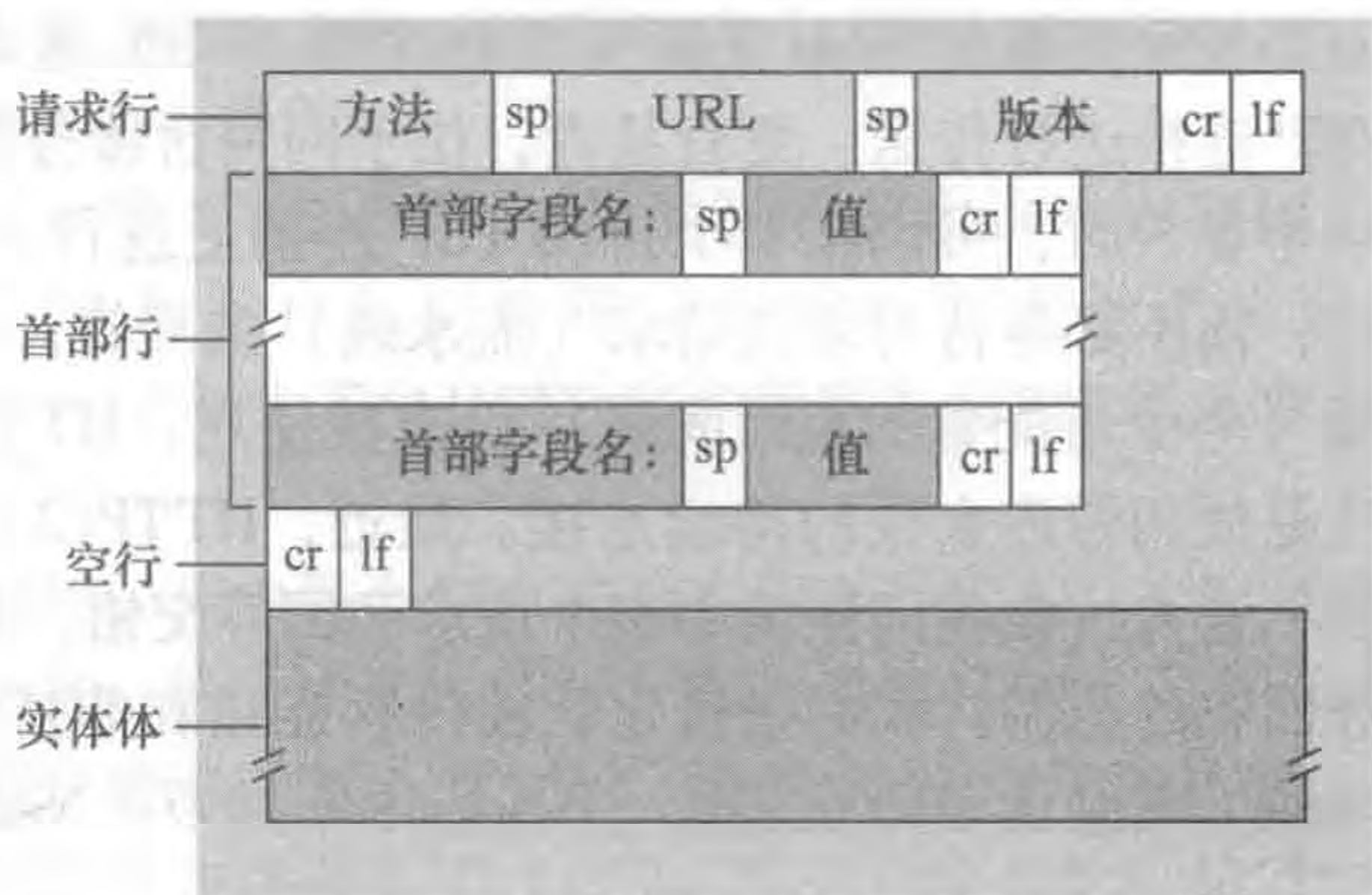
图 2-8 一个 HTTP 请求报文的通用格式
