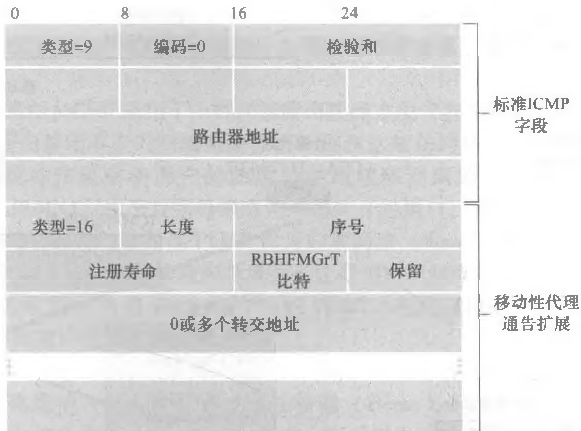
图 7-28 具有移动性代理通告扩展的 ICMP 路由器发现报文
