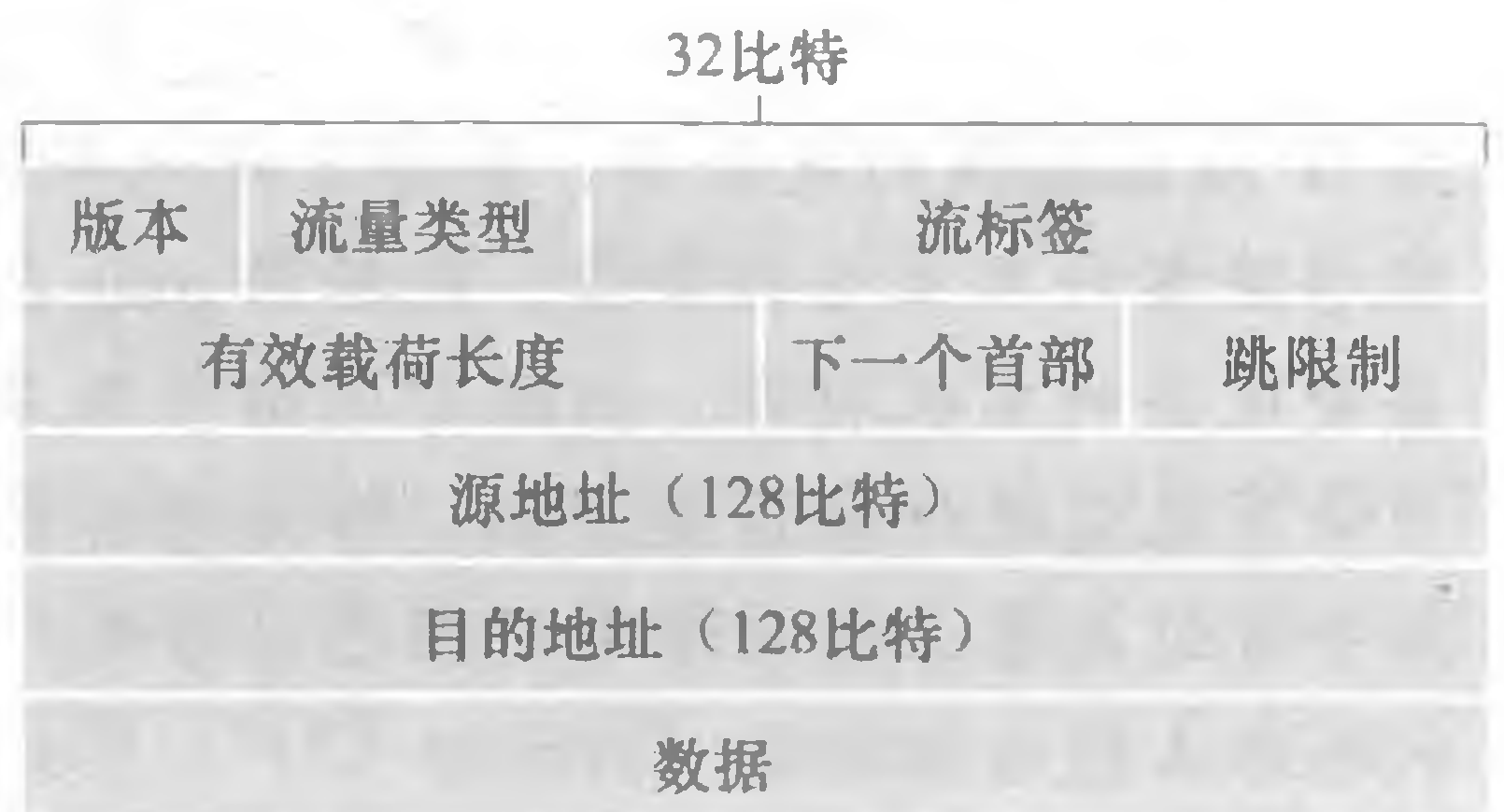
图 4-26 IPv6 数据报格式
