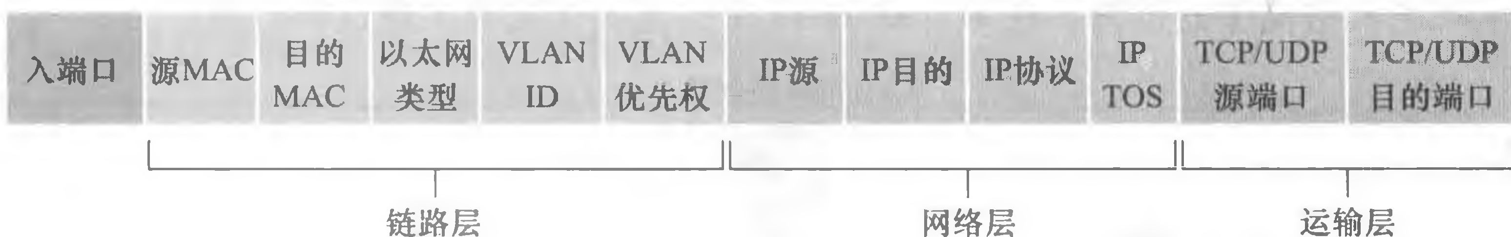
图 4-29 OpenFlow 1.0 流表的分组匹配字段
