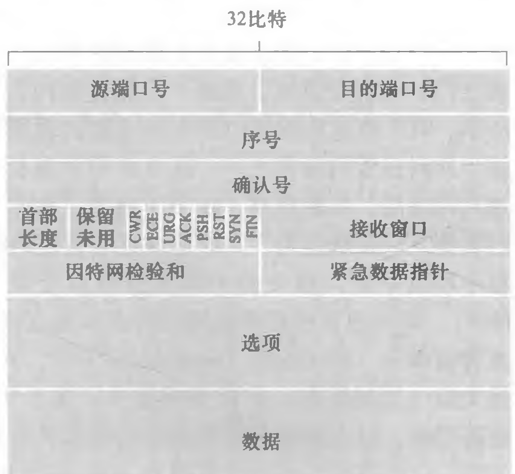
图 3-29 TCP 报文段结构
