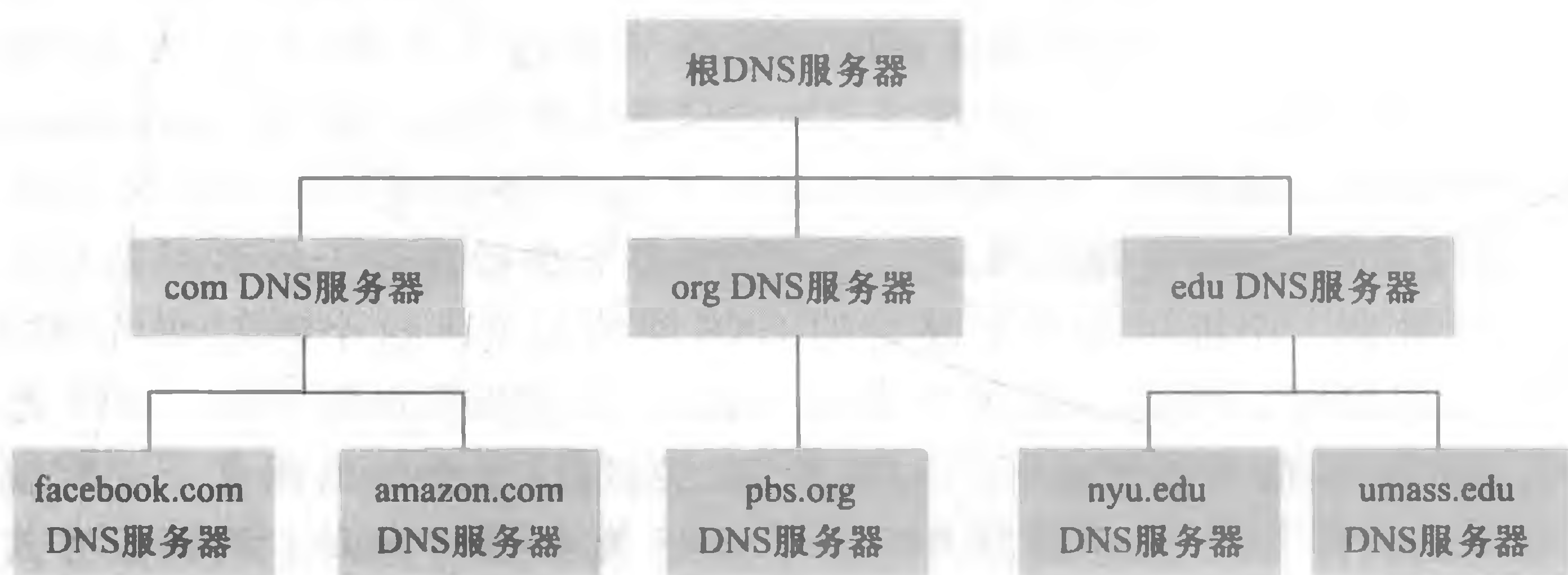
图 2-17 部分 DNS 服务器的层次结构
